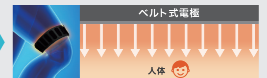
接触面積が大きいベルト式の電極
